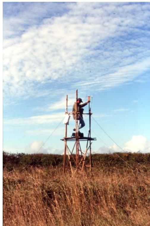
Les postes de réception se trouvent à 300 mètres l'un de l'autre, en bordure de marais. Ils permettent de couvrir toute la zone d'étude. S'élever de quelques mètres facilite la localisation des signaux émis par le radio émetteur.
